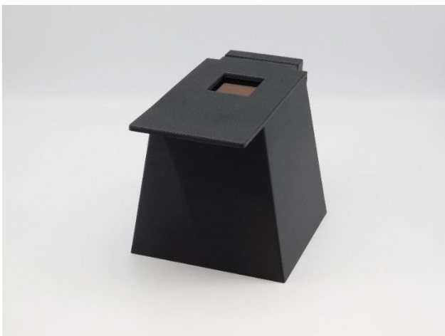
Рисунок 7. Система гелъдокументации "колпак"
