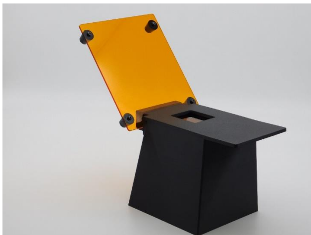
Рисунок 12. Крепление оранжевого светофильтра на колпаке
