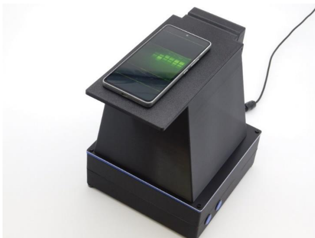
Рисунок 15. Гельдокументирование при помощи "колпака" и мобильного телефона
