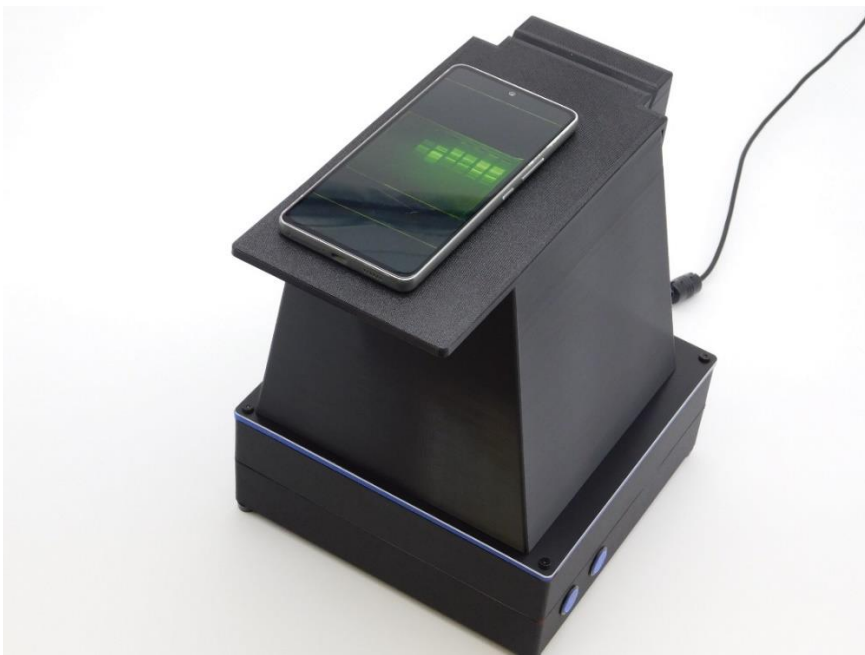
Рисунок 8. Гельдокументирование с помощью колпака и мобильного телефона (на данном рисунке установлен непосредственно на трансиллюминатор, однако также может устанавливаться и на доску для резки геля)
