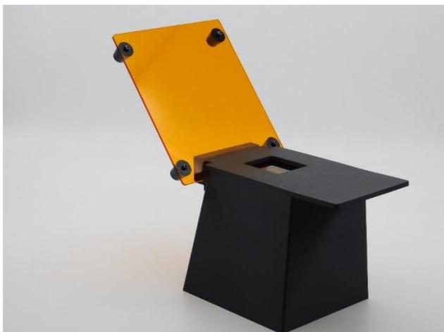
**Рисунок 12.** Крепление оранжевого светофильтра на колпаке
