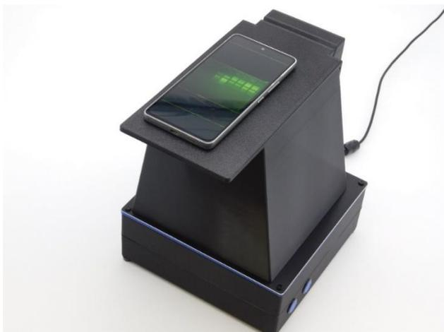
**Рисунок 15.** Гельдокументирование при помощи “колпака” и мобильного телефона
